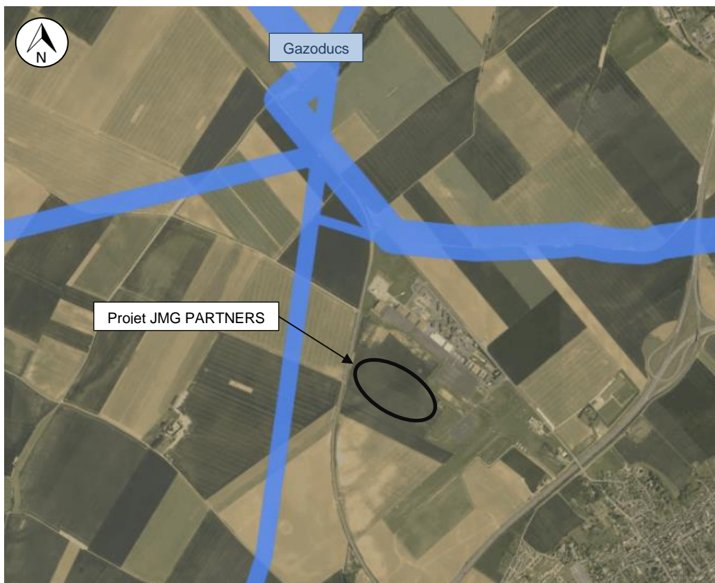
Figure 24 : Réseaux enterrés de gaz passant à proximité du site d'étude (source : Géorisques)
